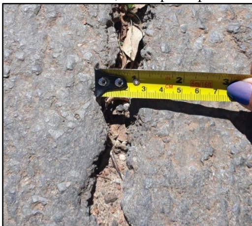
Figura 11 - Trinca com 2,5 cm após o período de chuva
